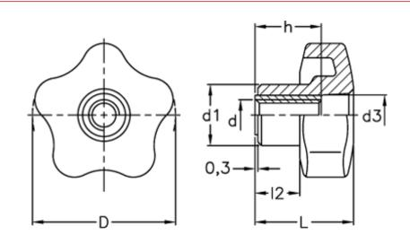
D = 74d1 = 26 d3 = 17 d 6H = M16 h = 31 L = 43.5 l2 = 22
